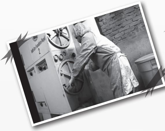
การบำบัด/กำจัดมูลฝอยติดเชื้อด้วยไอน้ำ (Autoclaves)
