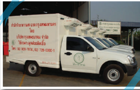
งานพาหนะขนส่งมูลฝอยติดเชื้อต้องพิมพ์ข้อความสีแดง "ใช้เฉพาะขนส่งมูลฝอยติดเชื้อ"
