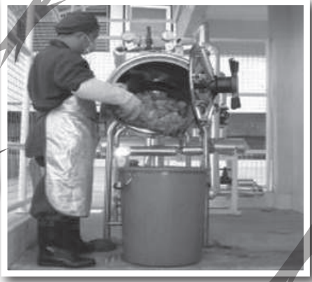
การบำบัด/กำจัดมูลฝอยติดเชื้อด้วยไอน้ำ (Autoclaves)
